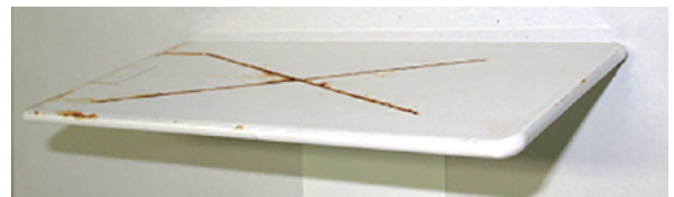
下塗 ニッシンバインダーホワイト 上塗 ニッシンパウダーPE ホワイト 標準膜厚
