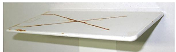
ニッシンバインダーを下塗に使用することで、端面の防錆力は大幅に向上します。
